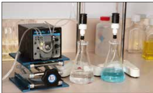
低流速泵适用于色谱、过滤、分配和其他应用
