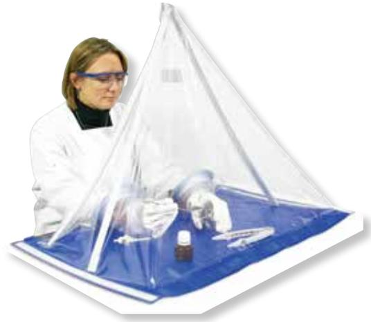
装置上带有 $1\frac{1}{2}$ " (47 cm) 宽的侧口用于放入物品，使用拉链可确保密封，还有一个通气口用于排出/通入气体。锥体由透明 250  $\mu$ m PVC 制成；带框架和 0.2-mm 厚丁基橡胶手套。
